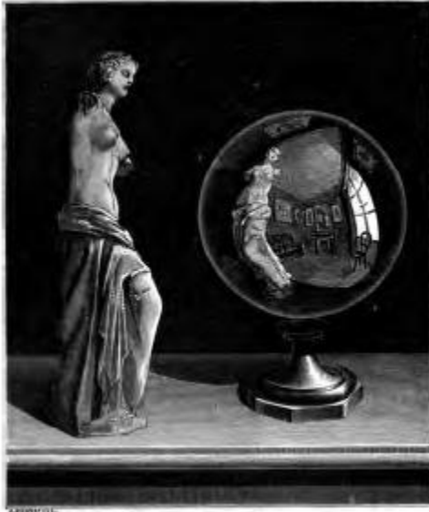
Fig. 58. — Image droite virtuelle dans les miroirs sphériques convexes.
