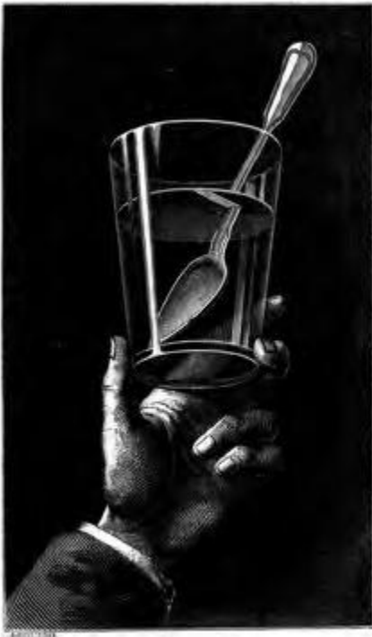
Fig. 78. — Phénomène de réflexion totale.
