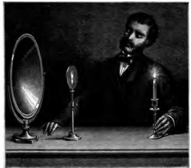
Fig. 49. — Miroir concave. Image renversée, plus petite que l'objet.
