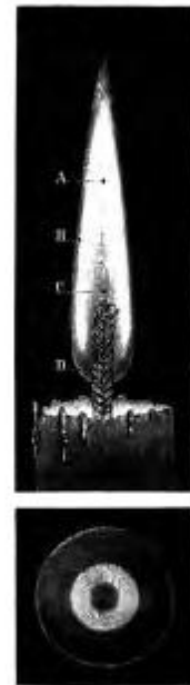
Fig. 149. — Structure de la flamme d'une bougie et coupe de la même flamme.
