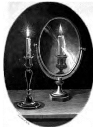
Fig. 51. — Miroir concave. Image virtuelle, droite et plus grande que l'objet.
