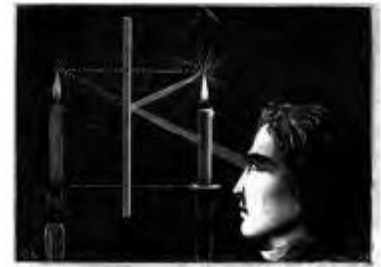
Fig. 39. — Formation des images vues par réflexion sur un miroir plan.
